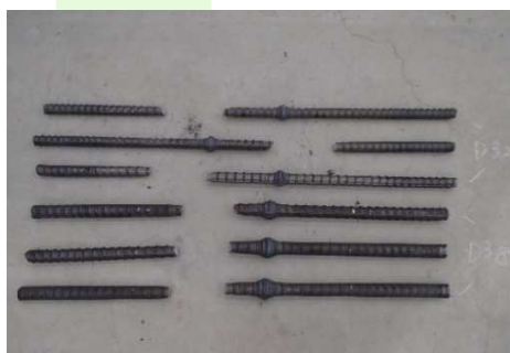
ガス圧接の引張強度試験
