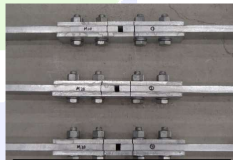
高力ボルトのすべり試験
