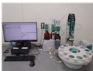
硬化コンクリート塩化物イオン量
