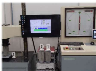
構造体コンクリート4週強度試験
