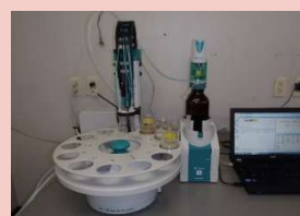
電位差滴定装置で塩化物イオン濃度を算出
