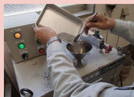
コアスライスまたは粉末試料を150μm以下に微粉砕
