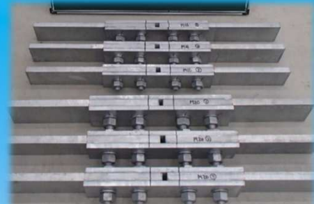
高力ボルトのすべり試験
