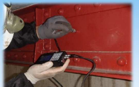
超音波板厚測定試験
