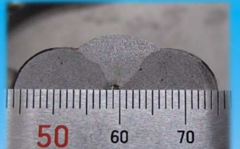
鋼の断面マクロ試験
