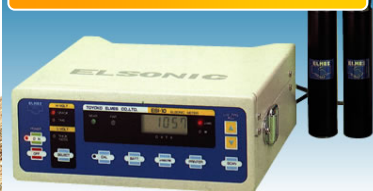
超音波法（土研法）による強度測定
